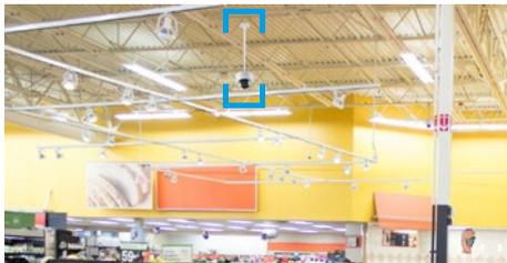
Die Deckenhalter eignen sich ideal, wenn bei einer direkten Deckeninstallation Gegenstände wie Kabelschächte, Lampen oder Stahlträger die Sicht versperren.
